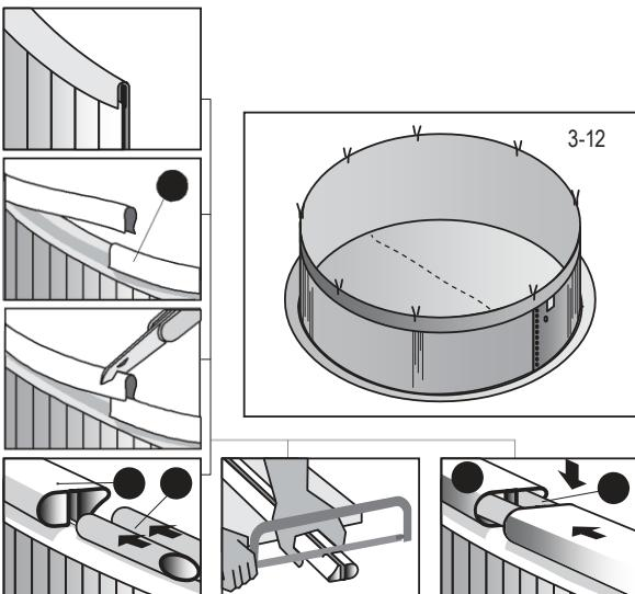
**Примечание:** Крепежные стержни [2] поставляются в двух вариантах – стержни без продольной прорези предназначены для нижней рамы, стержни с продольной прорезью (упругие) предназначены для верхней рамы.
